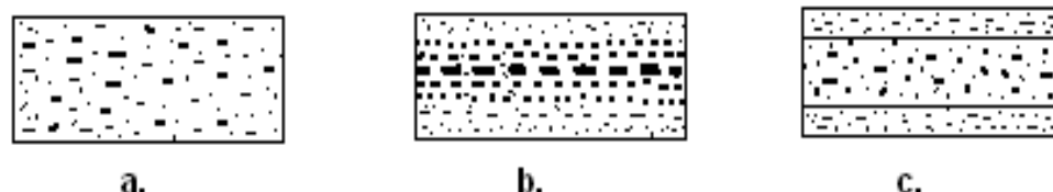
Fig 3.33. Clasificarea covoarelor de aşchii în funcție de structura: a-covoare unistratificate omogene; b-covoare unistratificate structurate; c-covoare tristratificate omogene.
